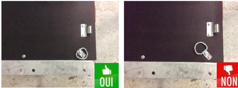
4) Positionner une fixation profilée à l'arrière de la remorque et fixer la avec une cale profilée en L. Faire de même à l'autre extrémité.
